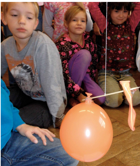
Abb. 2: Die Ballonwaage zeigt, dass Luft ein Gewicht hat.
